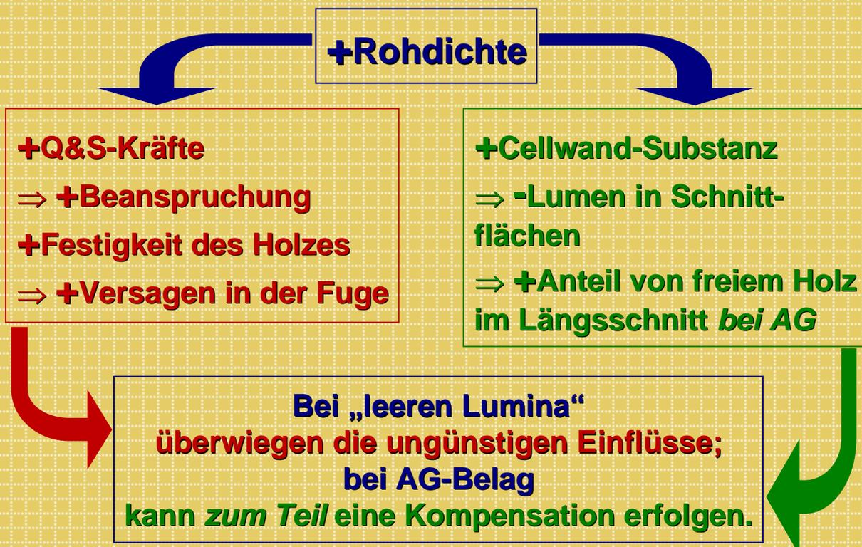
Höhere Rohdichten begünstigen in der Delaminierprüfung ein Versagen in der Fuge durch höhere Holz-Festigkeiten und gleichzeitig durch stärkere Beanspruchungen der Fugen infolge der stärkeren Quell- und Schwindungskräfte.
