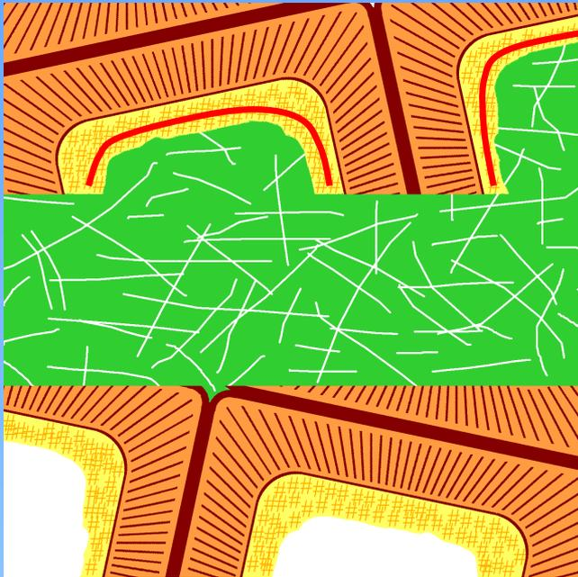
Auf den Cellinnenwänden wird das AG die ligninreichen  $S_3$ -Abschlußschichten **blockieren**: Der wasserfreie und wasserunlösliche Klebstoff wird das in Wasser gut lösliche, aber schon in "Alkohol" unlösliche AG nach der Hypothese nicht durchdringen können.
