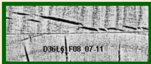
Zur Eigen- und Fremdüberwachung von Brett-schichtholz für die anspruchvollste Nutzungs-klasse sind den Bauteilen Proben mit vollstän-digem Querschnitt zu entnehmen und nach den Verfahren A oder B der Delaminierungs-prüfung nach [EN 391] zu prüfen [EN 386].
